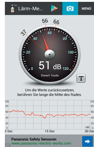
Abb. 1: Screenshot einer Messung; Momentanwert 51 dB(A); Mittelwert 56 dB(A) über 15 s
