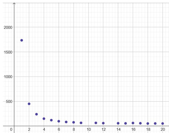
Es ist erkennbar, dass die Flussdichte mit kleiner werdendem Abstand zunimmt. Mit größerer Nähe zum Magneten nimmt auch der Anstieg der Messwerte zu. Man könnte einen indirekt proportionalen Zusammenhang vermuten, also in der folgenden mathematischen Form:
