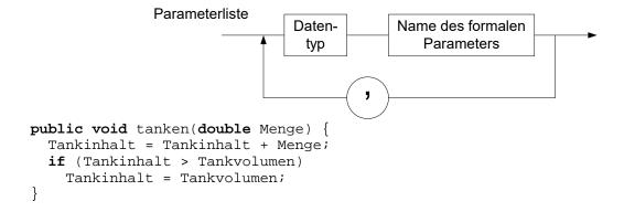
Beim Benutzen einer Methode werden anstelle der formalen Parameter aktuelle Parameterwerte eingesetzt. Dies können konstante Werte, Variablen oder auch komplexe Ausdrücke sein.
